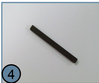
4 Восстановитель покрытия типа «карандаш» с зерном типа F 10x15x150мм
